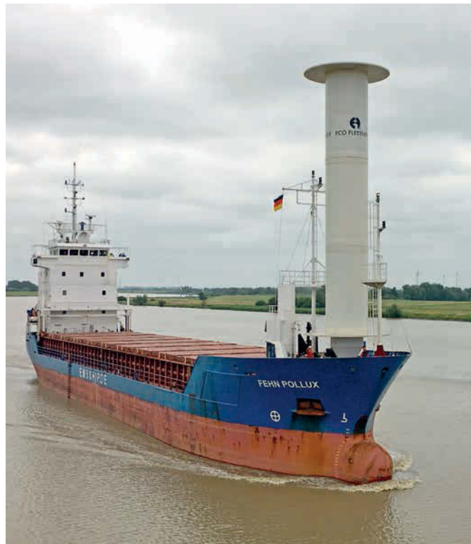
Windkraft für den Schiffsbetrieb: die „Fehn Pollux“ und ihr Rotorsegel
